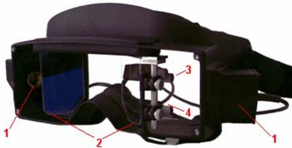
Abbildung 3: realisiertes headset (1 Kamera, 2 hot-mirrors, 3 IR-Sender, 4 IR-Empfänger)
